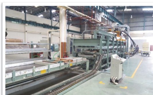
Dây chuyền sản xuất tấm cách nhiệt
