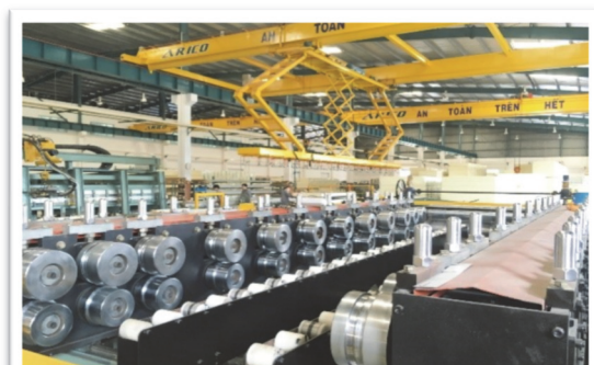
Dây chuyền tạo hình tole
